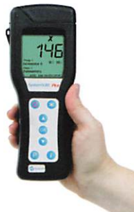
測定器： NITTA株式会社製 ルミノメーター(ATP拭き取り検査機)
