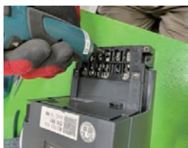
電気メーター（スマートメーター）解体
